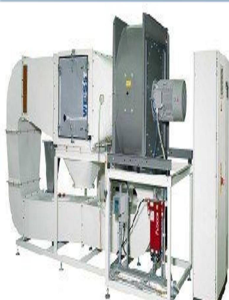
Test, kapalı bir deney hücresinde talk pudrasını askıda tutan uygun bir düzene, toz sirkülasyon pompasının değiştirilebildiği ana prensiplerle birleşik durumda olan bir toz hücresi kullanılarak yapılır
