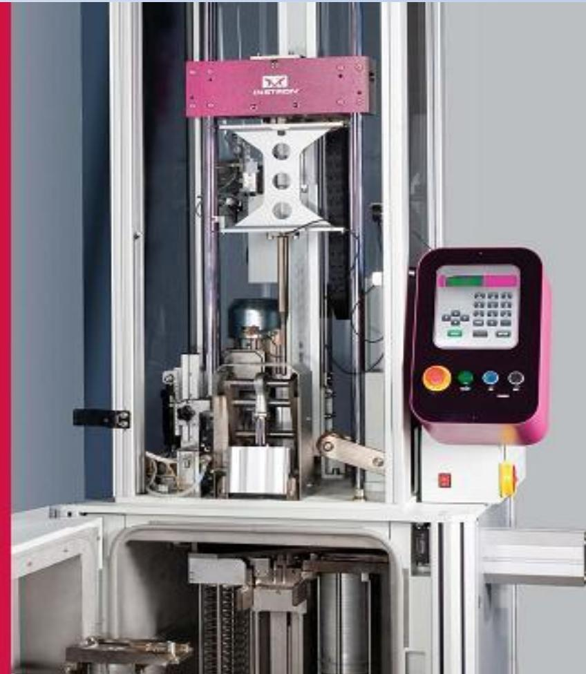
Elektriksel teçhizat, mahfazası veya metalik olmayan fan kapakları ile döner makinelerdeki havalandırma kafesleri dâhil metalik olmayan malzemeden yapılmış mahfaza bölümlerine sahip olduğunda bu deney, Madde 26.7.2'ye uygun olarak üst ve alt deney sıcaklıklarında yapılmalıdır
