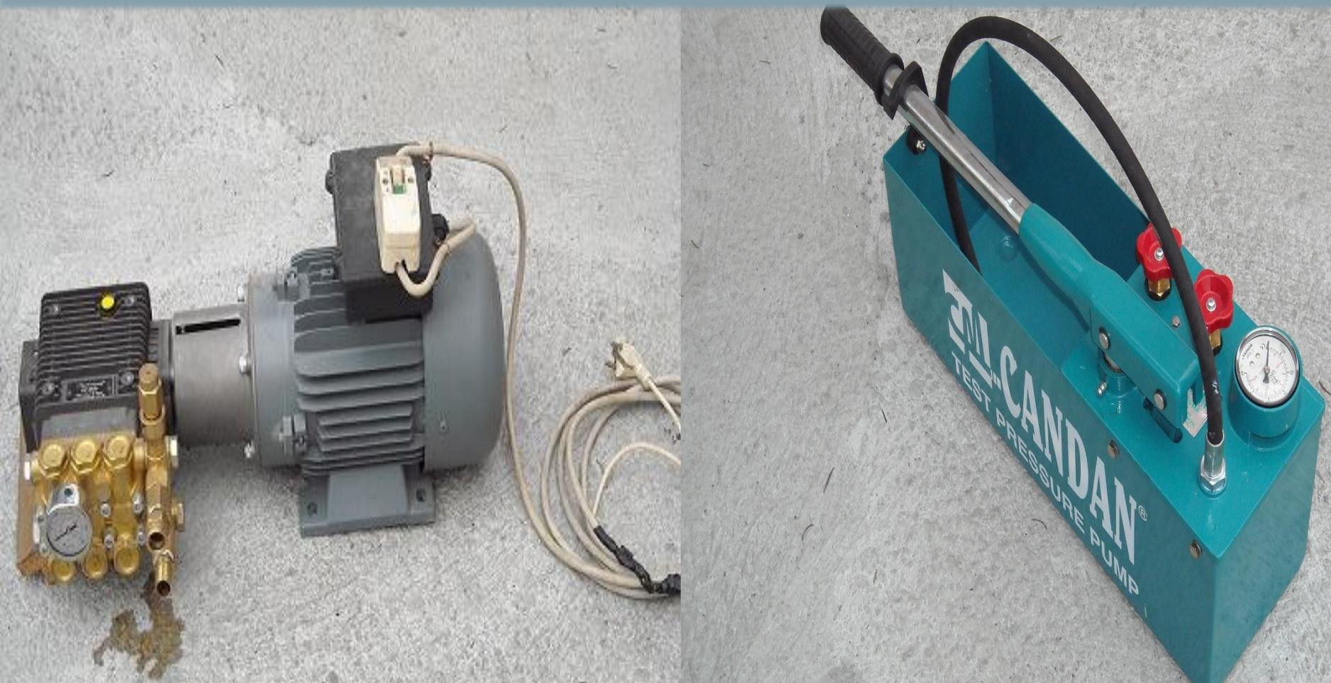
Hidrostatik Aşırı Basınç Testi Manuel Hidrolik Pompa
