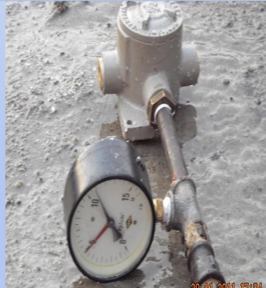
Hidrostatik Aşırı Basınç Testi - Manometre ile Ölçüm
