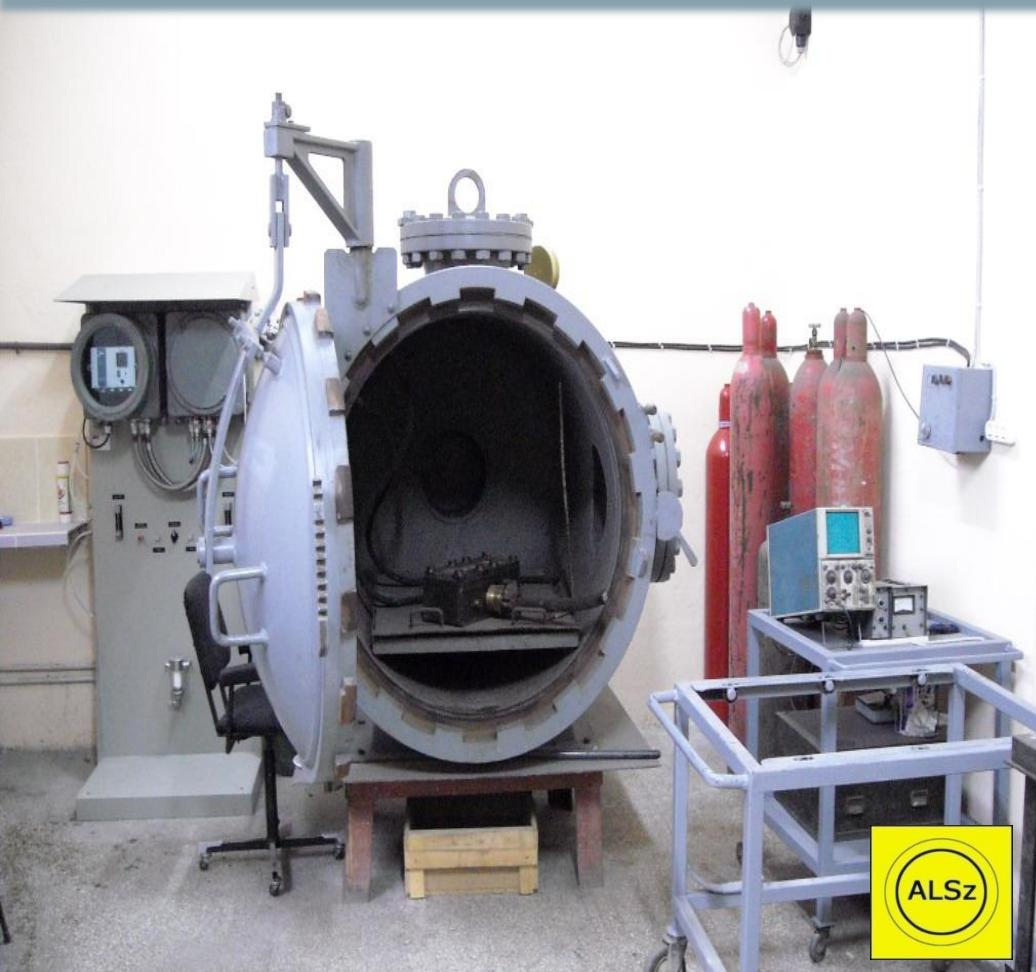
Aynı zamanda test edilecek teçhizatın dışında kalan hacme (kazan içine ) gaz doldurulur ve gaz analiz cihazı ile gaz karışımı patlayıcı oranlara getirilir
