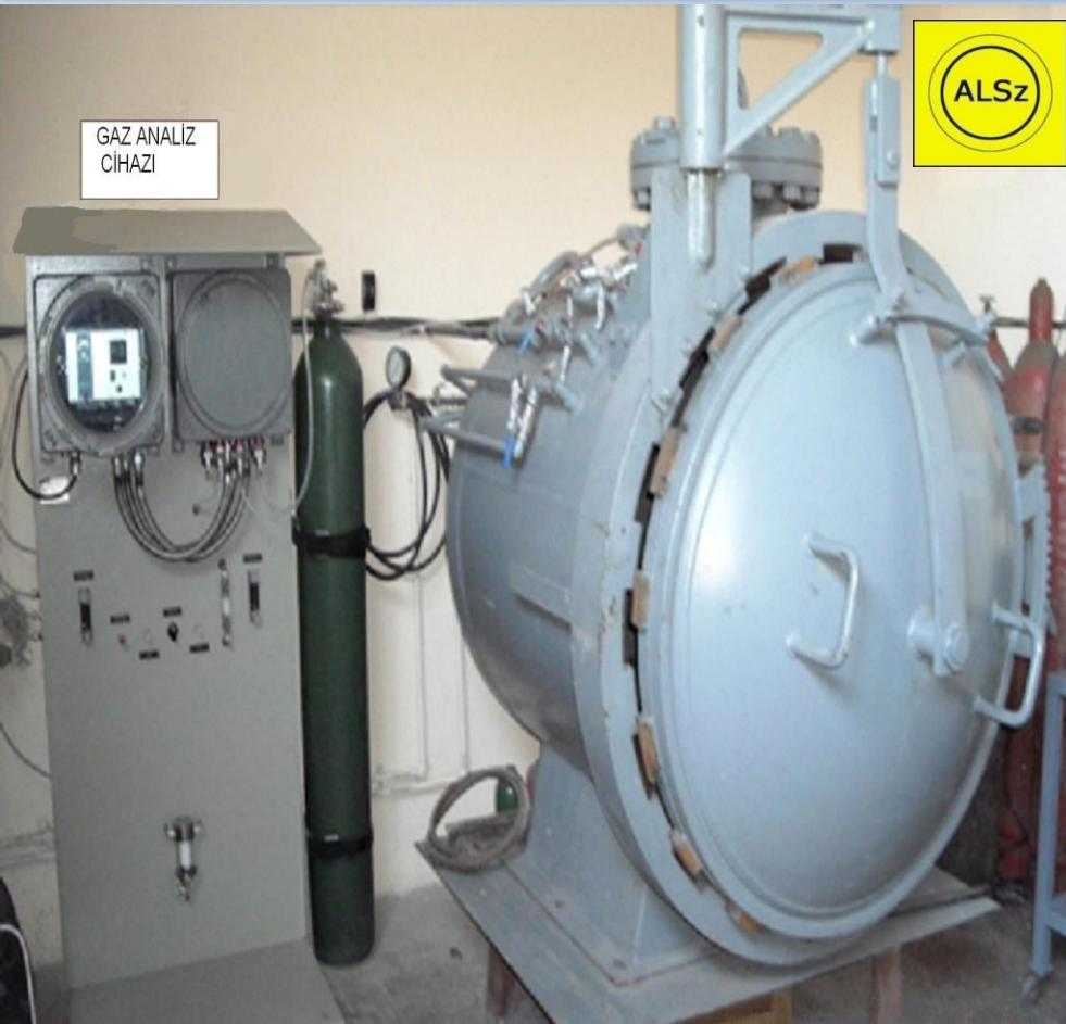
Gerek patlama basıncının belirlenmesi ve gerekse bir iç tutuşmanın iletilmemesi testinde kullanılan bu patlama kazanın içine yerleştirilen test edilecek teçhizat içindeki gaz-hava karışımı, teçhizata monte edilen bir buji ile patlatılır
