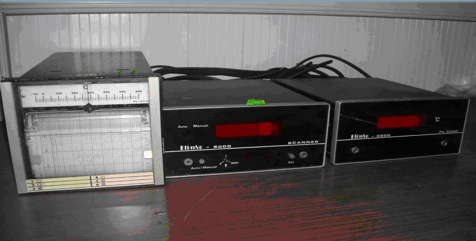
ELİMKO- 8000 En Büyük Yüzey Sıcaklığı Ölçme Düzeneği
