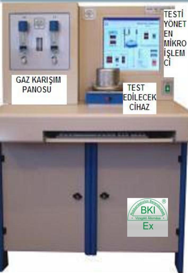
Akredite Onaylanmış Kuruluşu (Notified Body) olan Macaristanın BKI Test İstasyonunun Kendinden Emniyetlilik (Intrinsic Safety) testi ve gaz karışımını Micro Processor kullanılarak otomatik olarak yapan komple Kızılçım Test Cihazı
