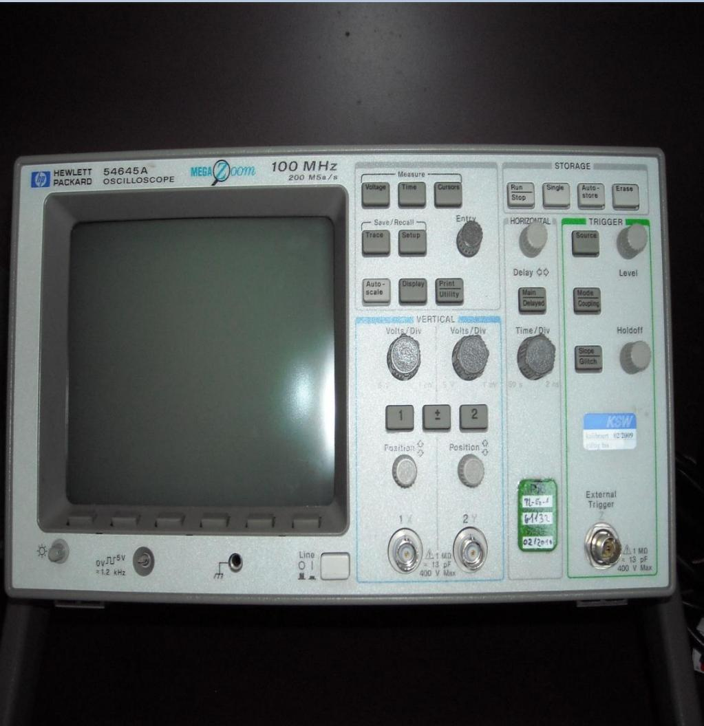
Yük amplifikatörü ile osiloskop arasındaki senkronizasyon sağlanarak hafızalı osiloskop üzerinden patlama basıncı tespit edilir
