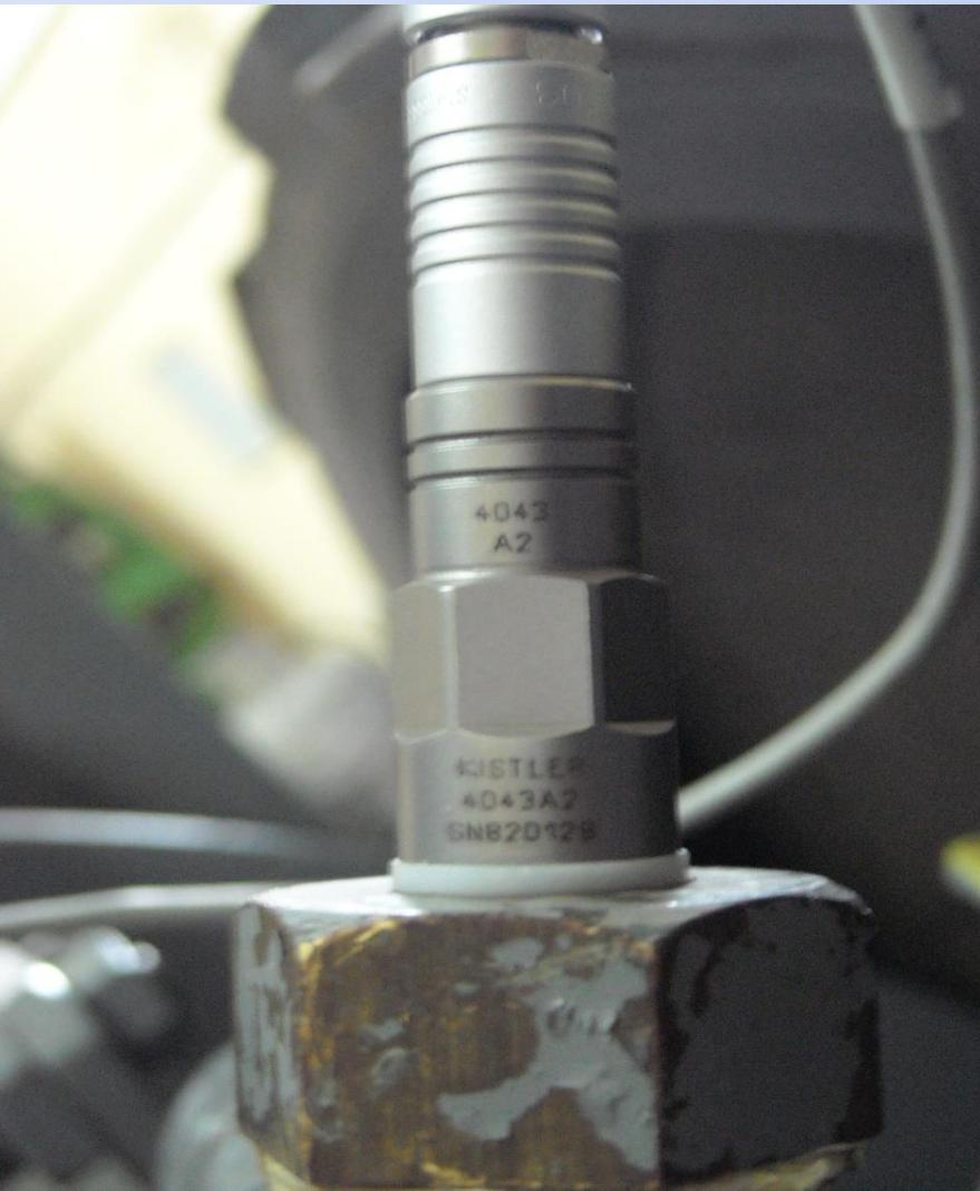
Patlama basıncı, kazan üzerinde bulunan piezoresistif bir basınç sensörü ile dışarıdaki basınç ölçme kitine aktarılır
